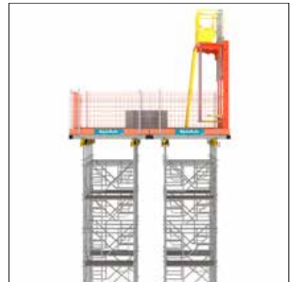
- Mise en garde (stabilité) : dans le cadre d'une charge ponctuelle de type lest de banche, se conformer aux plans fournis et modes opératoires spécifiques.
