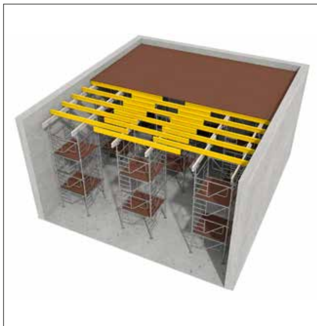
- Étaiment de dalles coulées en place réalisé avec des poutrelles AL200 et H20.
