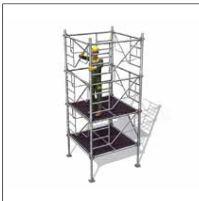
- Montage du 3 e niveau.
