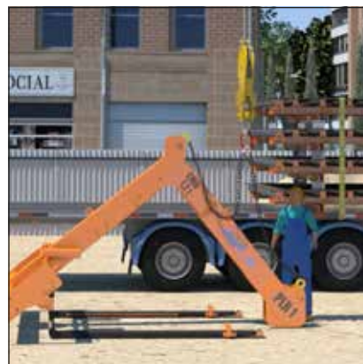
- Poser le palonnier au sol (il se replie).
